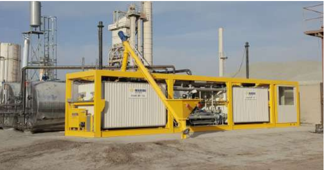
КУВЕЙТ - Установка ПБВ modiFALT15 до 15т/ч
